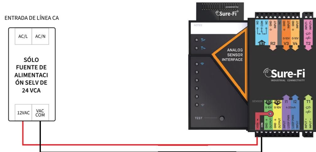
Cableado de alimentación típico para puente analógico que utiliza el canal de resistencia T1.
